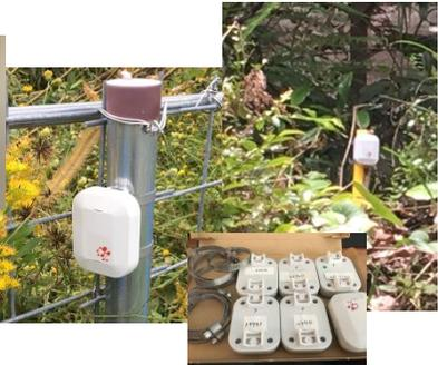
土砂崩れ予知用傾斜センサー
